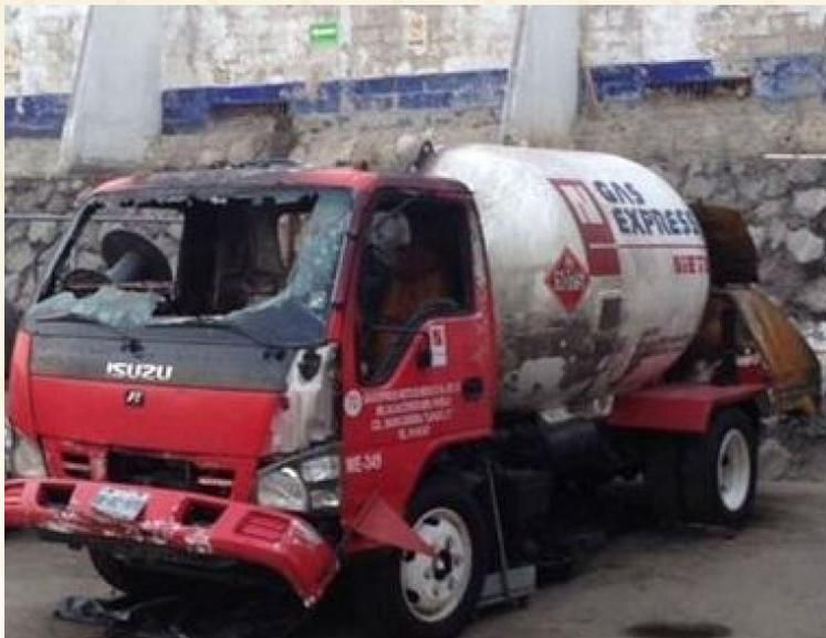
*“La fractura fue causada por la fatiga de los tornillos debido al mantenimiento deficiente, lo cual propició el derrame y vaporización del combustible formando una nube que, debido a las propiedades físicas del gas LP y a la inclinación del terreno, se introdujo en las instalaciones del hospital”*
