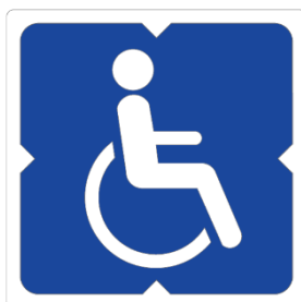
Imagen 17. Señalización visual que requiere incorporarse para identificación del área designada para personas usuarias de silla de ruedas, tamaño 150 mm por 150 mm, colocada sobre ventanilla adyacente.
