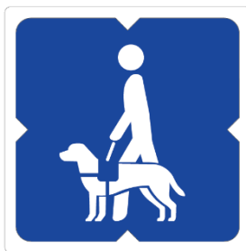
Imagen 18. Señalización visual que requiere incorporarse para identificación del área designada para persona acompañada de perro de asistencia, tamaño 150 mm por 150 mm, colocada sobre ventanilla adyacente.
