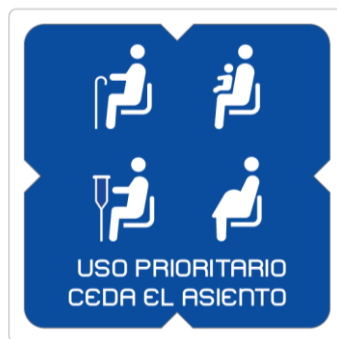
Imagen 16. Señalización visual que requiere incorporarse para identificación de los asientos designados para personas con movilidad limitada, tamaño 150 mm por 150 mm, colocada sobre ventanilla adyacente.
