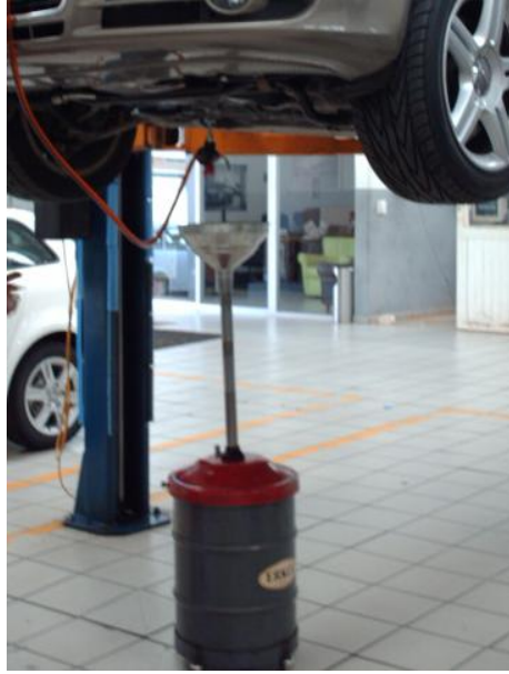
Figura 2. Dispositivo para captar aceite usado del cárter de un motor automotriz.
