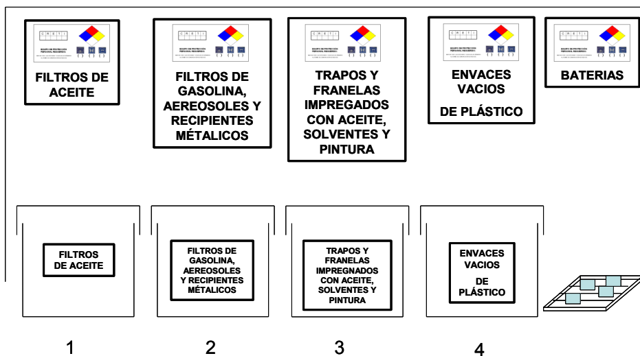
Figura 4. Delimitación de área de recepción de residuos peligrosos en el taller mecánico.
