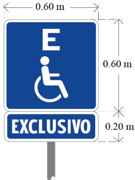
Imagen 4. Señal informativa SIS-77 “Estacionamiento para vehículos de personas con discapacidad” y tablero adicional con leyenda “EXCLUSIVO”.
